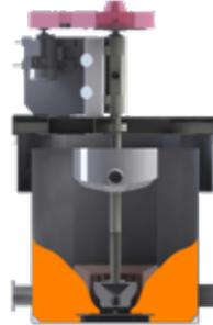
Благодаря специально разработанным импеллеру и статору, снижается запыление при остановке камеры и обеспечивается бесперебойный повторный запуск.
